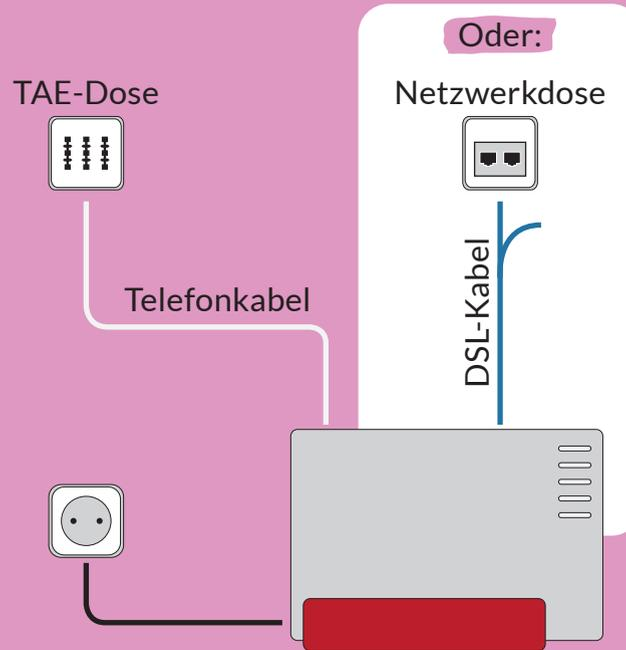
1. Schließe das Telefonkabel **4** an die TAE-Dose deiner Wohnung an. Das andere Ende verbindest du mit dem DSL-Anschluss an der FRITZ!Box. Alternativ kannst du das DSL-Kabel **5** mit einer Netzwerkdose (DSL 1) verbinden.
